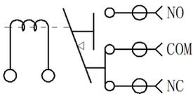
控制电压= 0V, COM与NC连接
